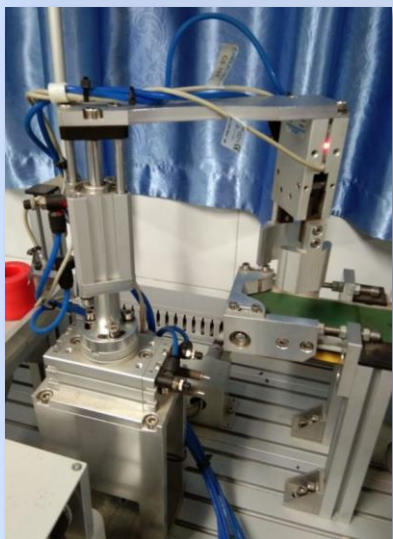
机械手在皮带输送机末端正确位置
