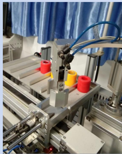
机械手在同步带平移台起始端正确位置
